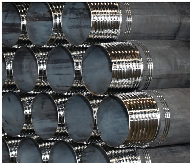
Les tiges de forage Di-Corp sont livrées avec des rainures indicatrices gravées à l'extérieur de la tige pour identifier rapidement le filetage. Une rainure pour le filetage R, deux rainures pour le filetage D, trois rainures pour le S-Maxx (photo) et aucune rainure pour le câble standard.
